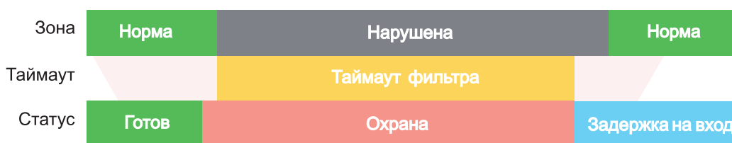
Рисунок 8. Начало задержки на вход по окончании таймаута после нарушения зоны Вход-выход.
